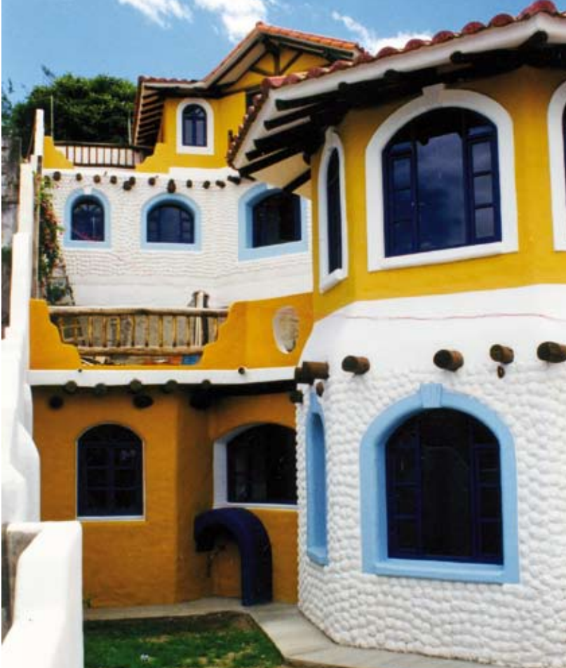
Ein Lehmhaus aus Quito (Hauptstadt von Ecuador), Architekten: Acosta und Guayasamin; Technik: Stampflehm, Lehmsteinbau und Nasslehmfüllung mit Holzskelettkonstruktion.
