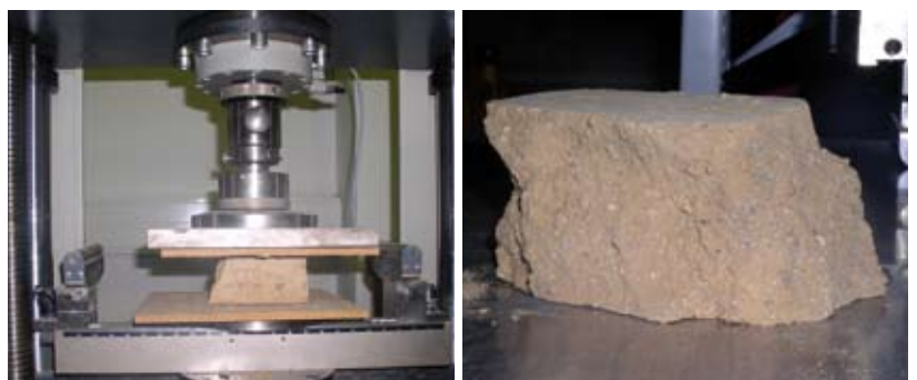
Bild 5: Prüfung eines Probekörpers auf Druck: links nach dem Einbau in die Prüfmaschine, rechts der zerstörte Probekörper nach dem Druckversuch.
